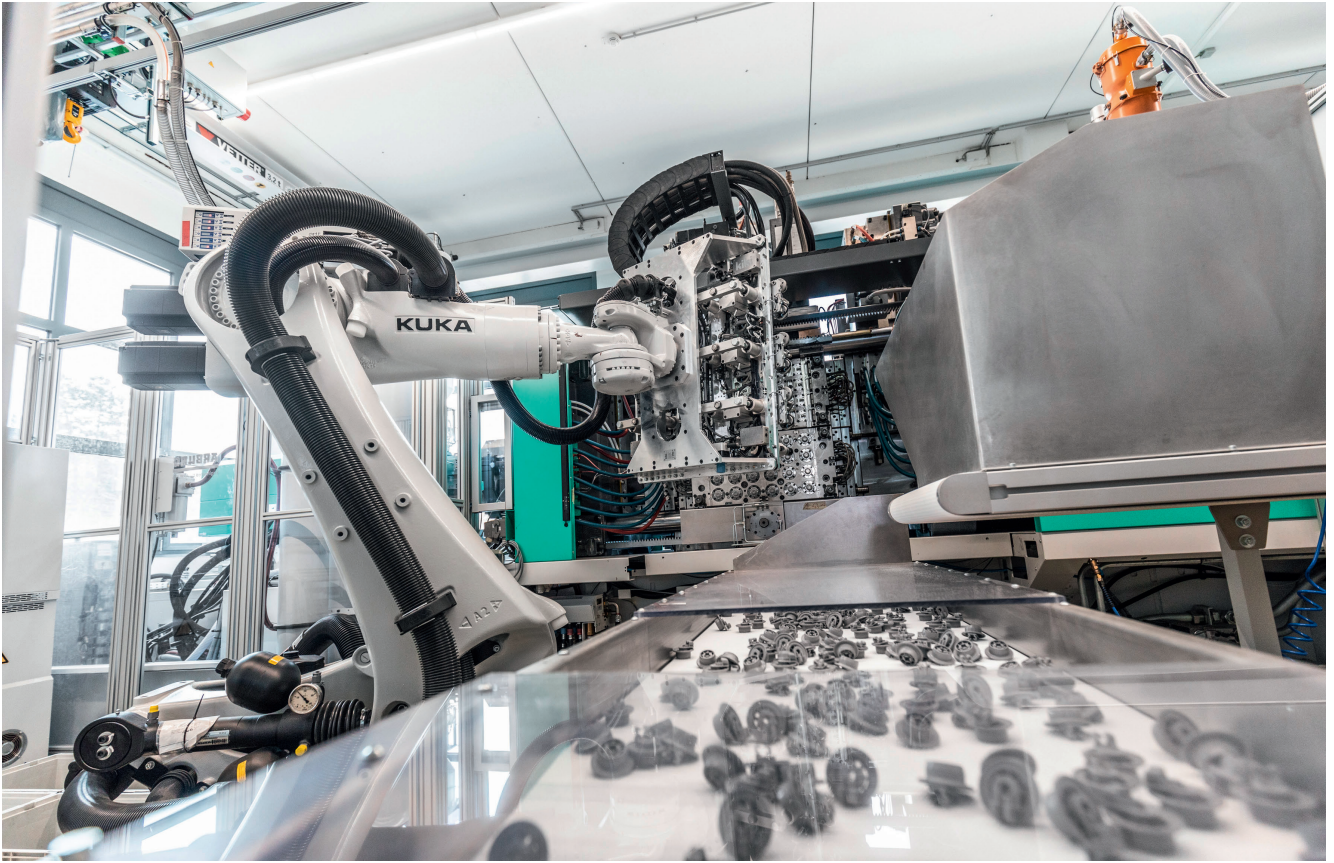
Ein KR Quantec entnimmt simultan zum Spritzzyklus die Oberkorbrollen aus dem unteren Teil des Würfels und setzt sie in die Steckbuchsen in der oberen Hälfte ein, um die fertigen Teile danach zu entnehmen. © Kuka
